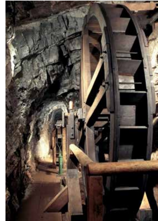
Modell einer Kunst zur Wasserhebung unter Tage im Besucherzentrum des Altenberg & Stahlberg e. V. Müsen. R.Golze.
